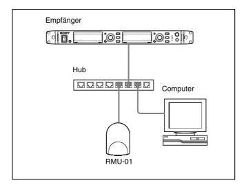
Verbinden Sie den Empfänger, RMU-01 sowie den Computer mit normalen Netzwerkkabeln über den Hub. Wenn die Netzwerkverbindung korrekt hergestellt wurde, leuchtet die LED am LAN-Anschlussbereich auf der Rückseite des Empfängers grün auf.
