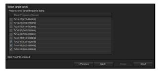
Die angezeigten Frequenzbänder sind identisch mit denjenigen, die für die Einstellung BAND des Empfängers ausgewählt werden können. In den folgenden Schritten kann der Kanalplan nur unter den hier ausgewählten Bändern ausgewählt werden.
