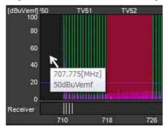
Die für die Empfänger konfigurierten Frequenzen werden als weiße Linien im Bereich Receiver angezeigt. Wenn Sie den Mauszeiger auf einer weißen Linie platzieren, werden Empfängername, Kanalnummer und Frequenz angezeigt.
