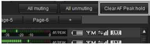
在 Status Viewer 中单击 [Clear AF Peak hold] 将释放所有显示的接收器通道峰值电平的保持状态
